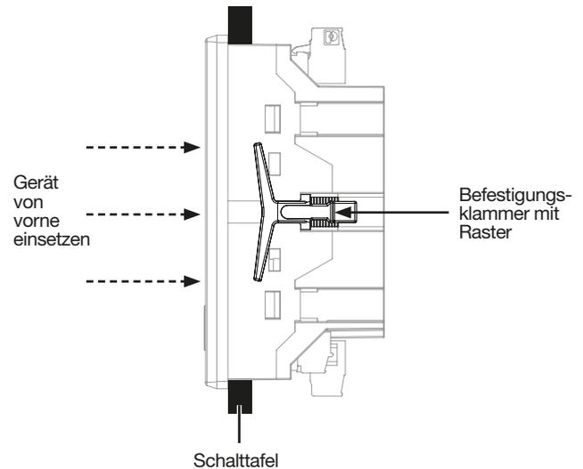
Abb. Seitenansicht des Geräts - Befestigung mit Rasterklammern.
