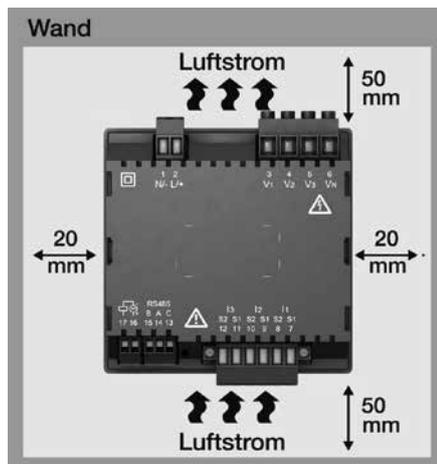
Abb. Rückansicht der Einbaulage des Geräts.
