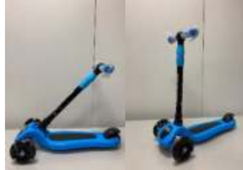
4. Duw de stuurstang omhoog tot deze vast klikt.
