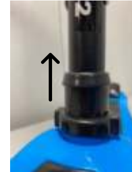
5. Trek de hendel omhoog om de stuurstang weer te kunnen inklappen.
