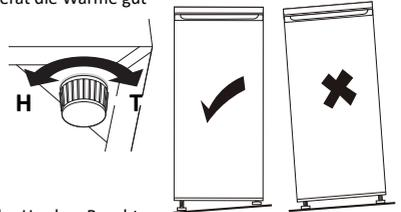
Stellen Sie das Gerät nicht in die Nähe von Wärmequellen wie Heizungen oder Herden. Beachten Sie die Klimaklasse des Geräts. Bei der Aufstellung in zu kühlen Räumen funktioniert der Gefrierschrank nicht gut.
