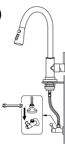
Assurez-vous que les deux tuyaux sont correctement raccordés à l'eau chaude et à l'eau froide, puis serrez-les fermement
