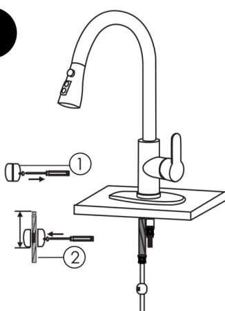
Fixez ensuite la boule de gravité au tuyau de raccordement
