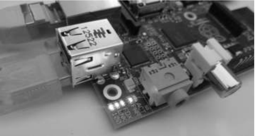
Afb. 1.2: De status-LED's op de Raspberry Pi.
