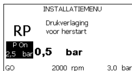
Afb. 17: Instelling van de herstartdruk
