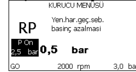
Şekil 17: Yeniden başlatma basıncının ayarlanması
