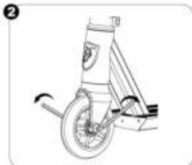
Ziehen Sie die Muttern wie abgebildet sicher fest.
